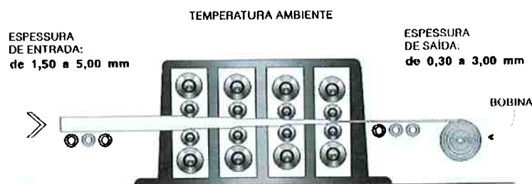
Figura 17 - Esquema de um Laminador de Tiras a Frio (21)
