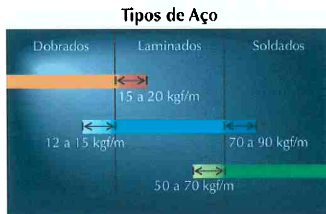
Figura 19 - Classificação dos tipos de perfis de aço (20)
